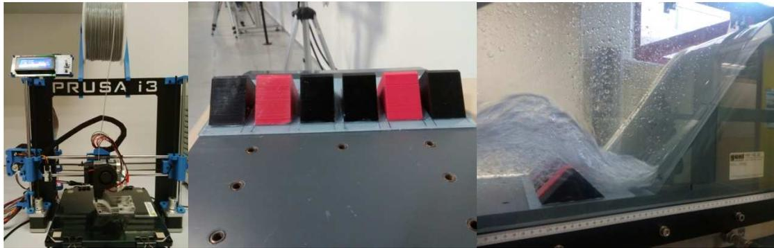
Figura 1. Izquierda) Impresión 3D de compuerta radial y de elementos de los desagües de fondo de una presa. Centro) Bloques de disipación en resalto hidráulico impresos; Derecha) Ensayo de los bloques de impacto en el canal de laboratorio de la UPCT.
